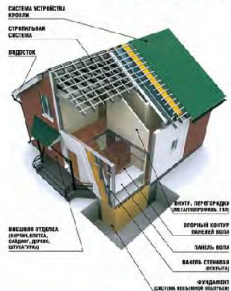
ПРИНЦИПИАЛЬНАЯ СХЕМА УСТРОЙСТВА ЗДАНИЯ НА ОСНОВЕ ПАНЕЛЕЙ ИЗ ТЕРМОПРОФИЛЯ
